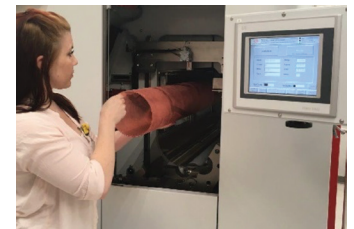
Jill Shemwell (Technikerin, Impact Innovations) entnimmt den verarbeiteten Sleeve aus dem Cyrel® FAST Round Prozessor.
